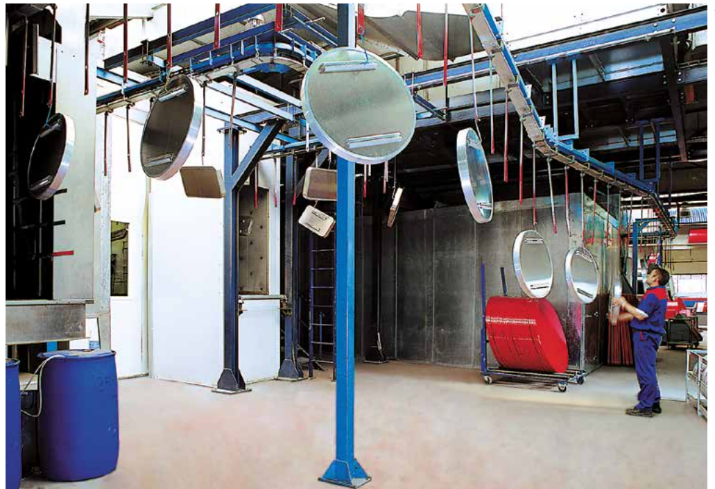
1 Pintura de señales en cadena cerrada continua:
