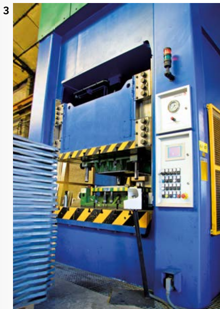
3 Prensa de 400 t para la estampación de señales
