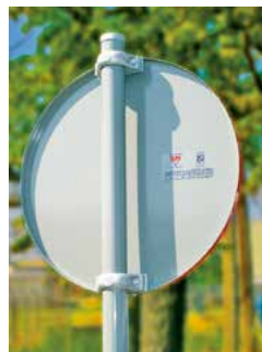
Señal estándar Formada por una chapa plegada con pestaña de 25 mm. Sistema de amarre a poste mediante pletina abrazadera.
