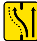
S-61 Desvío de un carril por la calzada opuesta, manteniendo otro por la de obras
