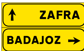
TS-220 Preseñalización de direcciones
