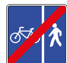
S-42 Fin de vía reservada para ciclos y peatones con espacio de circulación diferenciado entre ellos
