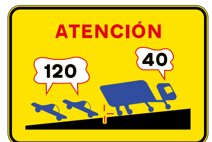
S-993 Advertencia de riesgo por alcances en un tramo de autopista o autovía en pendiente ascendente
