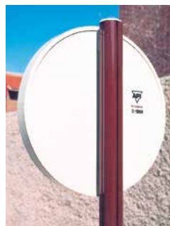
Modelo Sierra Nevada Formada por perfil perimetral extrusionado con dos chapas, frontal y trasera. Amarre a poste oculto mediante pletina especial. El poste será ranurado D-80 (exclusivamente).
