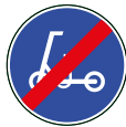
R-515 Fin de vía reservada y obligatoria para vehículos de movilidad personal
