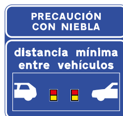
S-992e Señal informativa de la distancia mínima entre vehículos indicada mediante balizas luminosas
