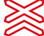
P-11a Situación de un paso a nivel sin barreras de más de una vía férrea
