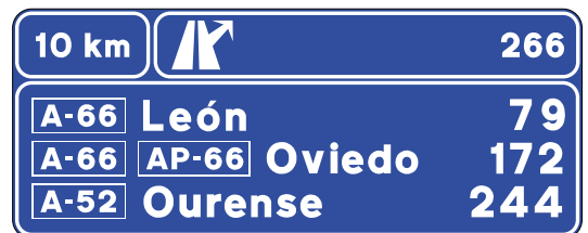
S-603 Confirmación complementaria con preseñalización de salida
