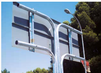
Báculos de isleta de 4 tubos (para señalización informativa tipo A.I.M.P.E.)
