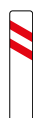
P-10b Aproximación a un paso a nivel, puente móvil o muelle (150 m, lado izquierdo)
