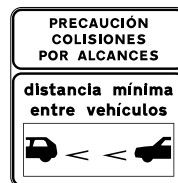
S-992a Señal informativa de la distancia mínima entre vehículos en carretera convencional
