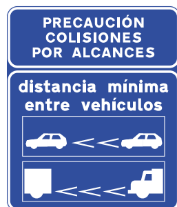
S-992d Señal informativa de la distancia mínima entre vehículos dentro de un túnel en autopista o autovía
