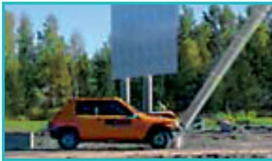
Los más de 50 *crash test* realizados por la U. Tecnológica de Helsinki demuestran que la instalación de las columnas JEROL podrían reducir el número de muertes en este tipo de colisiones hasta un 40 %.
