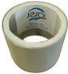
La columna de señalización JEROL absorbe impactos, consta de 2 capas, una capa interior de poliéster reforzado con fibra de vidrio (PRFV) mediante *pull winding* y una exterior de poliolefina unidas mediante un proceso de coextrusión.
