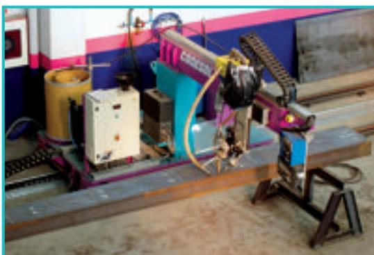
Soldadura automática por arco sumergido
