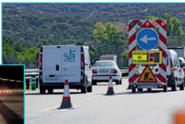
Carro de señalización con cascada luminosa y radar incorporados
